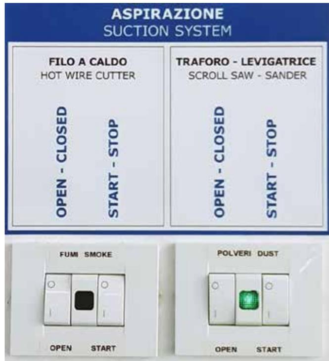
**Apri la serranda** inferiore, posta sul tubo di aspirazione, in corrispondenza della macchina che vuoi utilizzare, ruotandola in posizione verticale.
